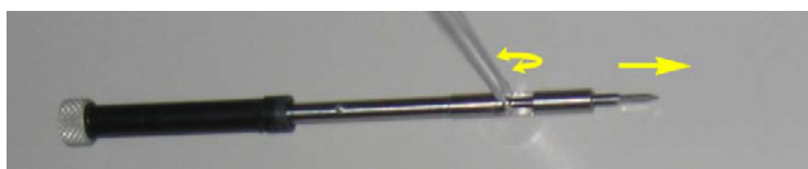
FIG 1-32 RIMOZIONE DELLA LAMA DAL PORTA-LAMA TANGENZIALE
