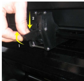
FIG 5-1 SOLLEVARE LA ROTELLA DI TRASCINAMENTO
