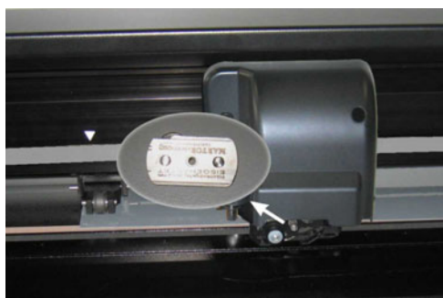
FIG 1-35 LAMA DA RASOIO PER TAGLIO VINILE DOPO L'ESECUZIONE DEL LAVORO
