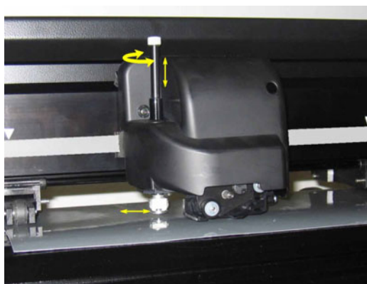
FIG 1-31 RIMOZIONE DEL PORTA-LAMA TANGENZIALE
