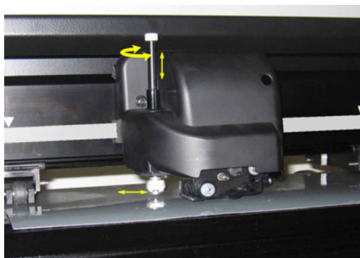
FIG 1-34 INSERIMENTO DEL PORTA-LAMA TEANGENZIALE
