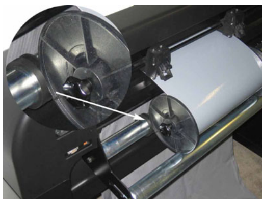
FIG 1-22 POSIZIONE DEL ROTOLO CON LE FLANGE SUL PLOTTER
