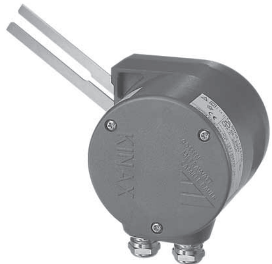
Bild 2. Stellungen-Rückmelder KINAX SR 709, Anschlusshebel in Ruhestellung nach oben gerichtet, entspricht Ausgangsstrom 0/4 mA.
