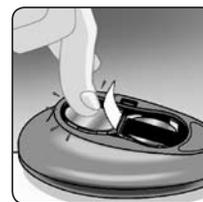
Si le lecteur ne se met pas en marche après le remplacement de la pile, vérifier que la pile est correctement installée avec le signe « + » sur le dessus. Si le lecteur ne s'allume toujours pas, contacter le Service OneTouch® au 0800/7077007 (Allemagne), 0800/14660 (Belgique), 800/25749 (Luxembourg) et 0800/244245 (Autriche).
