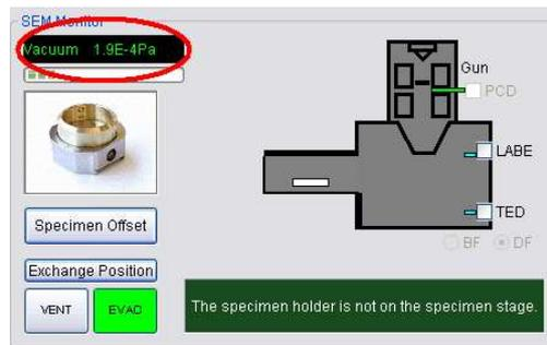
Figure 8: Lecture de la pression dans la chambre d'analyse
