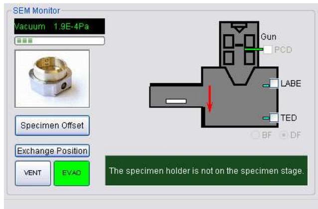
Figure 5: Schéma du microscope du logiciel
