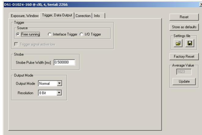
Figure 8.8: DS1-D1024-160 trigger and data output panel
