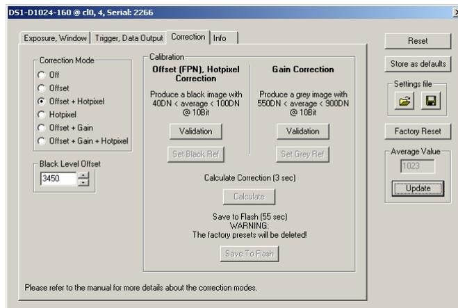
Figure 8.9: DS1-D1024-160 correction panel
