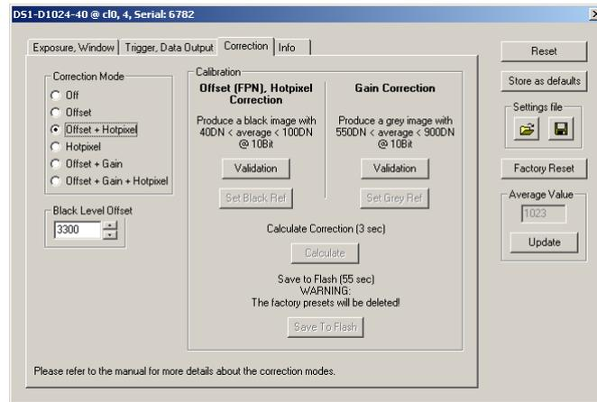
Figure 8.4: DS1-D1024-40 correction panel
