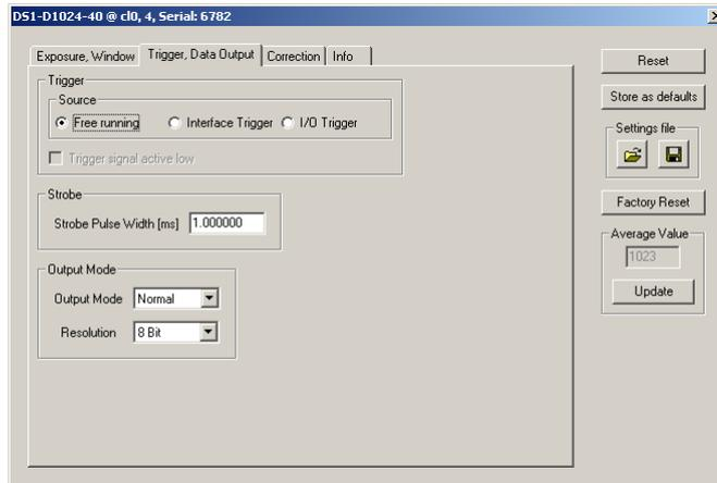
Figure 8.3: DS1-D1024-40 trigger and data output panel
