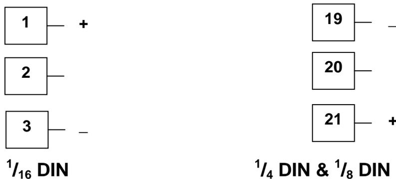
Figure 20. Option Slot 1 - Triac Module
