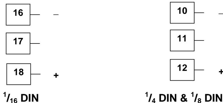
Figure 28. Option Slot 3 - SSR Driver Module
