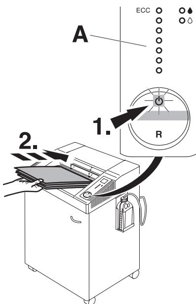
**NL** Schakelaar indrukken (1.) : groen licht gaat aan, machine is bedrijfsklaar. Start automatisch zodra papier wordt ingevoerd. Automatische standby schakelt naar 30 minuten uit. De machine kan op elk gewenst moment worden uitgeschakeld door gedurende 2 seconden op de knop te drukken. Groene LED controlelampje is uit. De machine verbruikt dan geen stroom meer.
