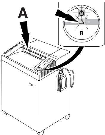
**NL** Automatische stop als de veiligheidsklep (A) geopend wordt (Symbolen  $\Delta$  en  $\odot$  knipperen afwisselend.)
