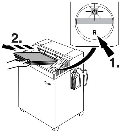
**D Bei Bedarf:** Schalter "R" drücken, Papier entnehmen. (Maschine läuft nur kurz rückwärts, bei Bedarf mehrmals wiederholen).
