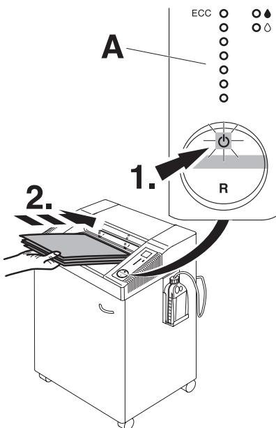
**D** Schalter drücken (1.) : grünes Licht leuchtet, Maschine betriebsbereit. Autom. Anlauf bei Papierzufuhr. Autom. stand/by - Abschaltung nach 30 Minuten. Maschine kann jederzeit durch 2 sec. langes Drücken des Schalters ausgeschaltet werden. Grüne Kontrollleuchte erlischt. Danach verbraucht die Maschine keinen Strom mehr. Hinweis: **IDEAL 2604, 3104, 3105, 4002 und 4005** Maschinen haben eine **ECC- Anzeige (Electronic Capacity Control)** zur Leistungsanzeige beim Vernichten des Papiers (A).
