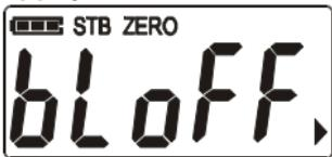
Appuyer sur **HOLD/UNIT** pour changer la configuration du rétro éclairage.
