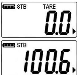
Appuyer sur **TARE/ZERO** pour effacer la tare. Rétablir la tare. Le voyant de la TARE est désactivé. Le poids affiché à l'écran est le poids brut. Après l'effacement, il est possible d'exécuter de nouveau la tare si un nouveau produit doit être ajouté sur la balance.
