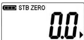
ZERO wird angezeigt. Das angezeigte Gewicht schaltet auf "0.0" oder "0.00". Die jeweilige Anzeige auf den Display schaltet sich ein.
