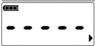
La visualizzazione mostra il messaggio durante la rilevazione del peso per l'esecuzione dell'auto-zero.
