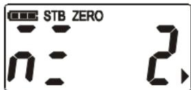
Drücken Sie **HOLD/UNIT**, um Änderungen bei der Option „manuelle Nullstellung“ durchzuführen. Die manuelle Nullstellung kann auf 0%, 2%, 4%, 10%, 20% oder 50% des Maßstabs / Wägebereichs eingestellt werden.
