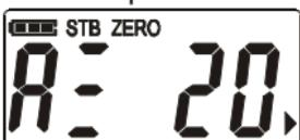
Appuyer sur **HOLD/UNIT** pour changer la configuration du zéro automatique. La plage du zéro automatique peut être configurée à 0%, 2%, 4%, 10%, 20% ou 50% de la portée du crochet peseur.
