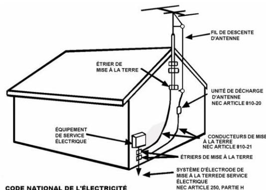
16. **ECLAIR**-Pour une protection supplémentaire de l'appareil durant un orage électrique, ou lorsque vous le laissez sans surveillance et vous ne l'utilisez pas sur une longue période, débrancher-le de la prise murale et déconnectez l'antenne ou le system de câble. De cette façon, vous éviterez tout dommage à l'appareil qui pourrait être causé par un éclair et par les surcharges sur la ligne de courant.
