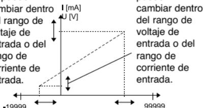
El voltaje de entrada mínima o la corriente de entrada mínima se pueden cambiar dentro del rango de voltaje de entrada o del rango de corriente de entrada.
