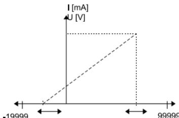
El valor que se muestra se puede ajustar libremente en el valor de entrada dentro del rango de pantalla.
