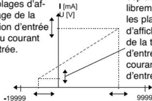
La tension maximum en entrée ou le courant maximum en entrée peuvent être déplacés librement dans les plages d'affichage de la tension d'entrée ou du courant d'entrée.
