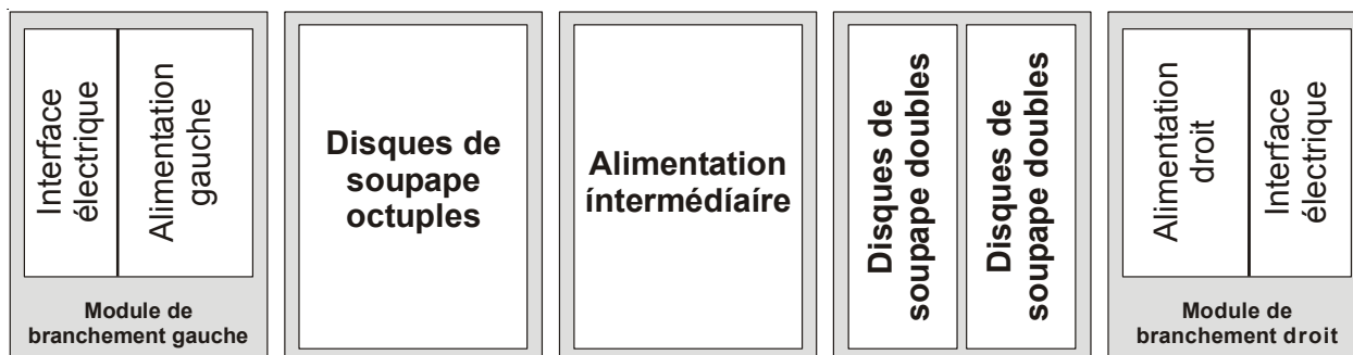
Exemple schématique d'un bloc pneumatique
