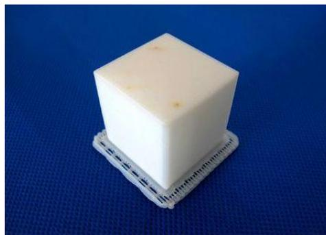
Modelo: 30x30x30mm    espessuras da camada: 0.2mm
