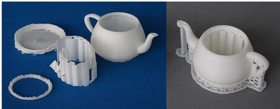
Modelos impressos são compostos por duas partes. Uma parte é o modelo em si, e a outra parte é o material de apoio usado para suportar todas as partes salientes do modelo.
