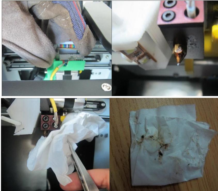
DICA: Muitos usuários também colocam o bico em acetona para limpá-los, ou mesmo usar um banho de limpeza ultra-sônica para ajudar a limpar o bico.
