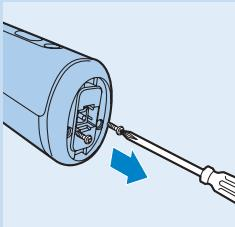
**2** Retire os dois parafusos da parte inferior do cabo usando uma chave de fenda.
