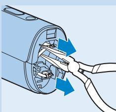
**4** Remova os conectores da bateria dos terminais com um alicate de ponta chata.
