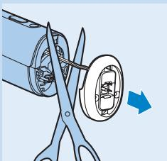
**3** Remova a parte inferior do cabo e corte os dois fios que conectam a parte inferior ao aparelho.
