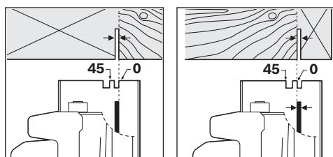
A marcação de corte de  $0^\circ$  (**11**) indica a posição do disco de serra para cortes perpendiculares. A marcação de corte de  $45^\circ$  (**10**) indica a posição do disco de corte para cortes de  $45^\circ$ .
