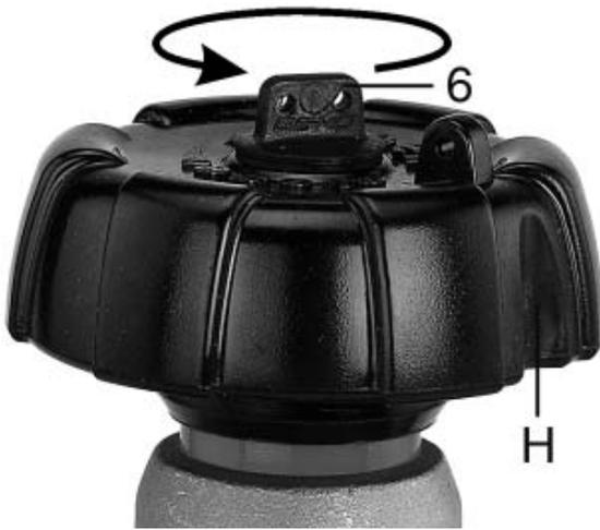
2. Arretierungsschraube **6** lösen, heraus drehen und entfernen.
