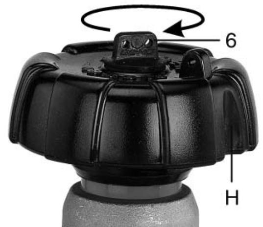
10. Handrad **H** in richtiger Position auf den Zweiflach der Ventilspindel aufstecken
