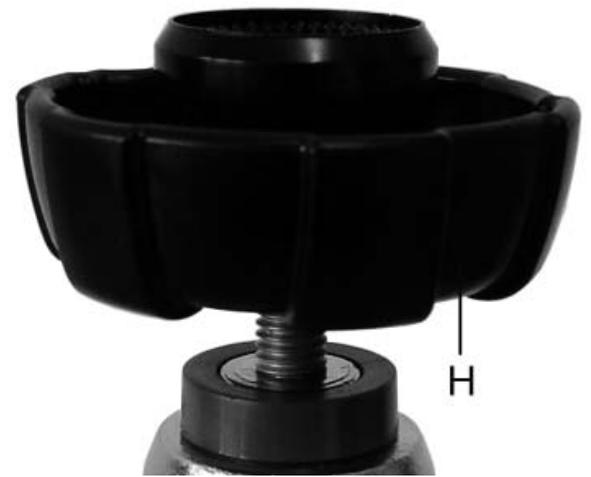
6. Handrad **H** 180° verdreht auf den Zweiflach der Ventilspindel aufsetzen.
