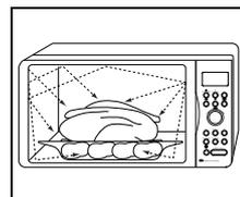
1. Микроволны, генерируемые магнетроном, отражаются стенками внутренней камеры печи и равномерно распределяются в пище, благодаря тому, что она вращается на подносе. За счет этого пища готовится равномерно.
