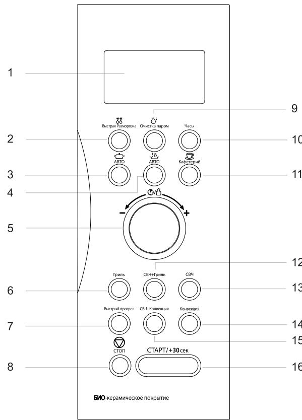
7. КНОПКА РЕЖИМА БЫСТРОГО АВТОМАТИЧЕСКОГО ПРОГРЕВА
