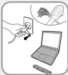
**Отсоедините все кабели, подключенные к компьютеру, перед его очисткой. Если ноутбук работает от внешней съемной батареи, отключите внешнюю батарею.**
