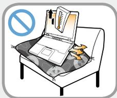
**Не перекрывайте вентиляционное отверстие снизу и сбоку компьютера, когда он используется на кровати или диване.**
