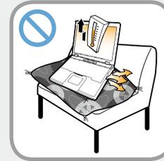
**Во избежание перегрева не используйте компьютер в местах с плохой вентиляцией, например на постельном белье, на подушке и т.д., а также в помещении с подогреваемым полом.**
