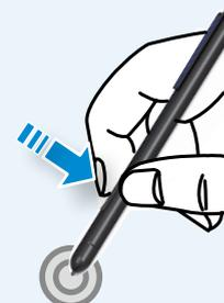
При нажатии клавиши пера, когда кончик S Pen на экране, вокруг наконечника на экране появляются круги. Коснитесь экрана S Pen с нажатой клавишей пера.
