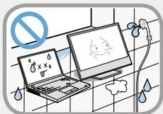
**Не устанавливайте устройство в местах, подверженных высокой влажности, например в ванной комнате.**
