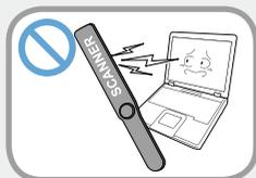
Не подвергайте диск воздействию магнитных полей. Магнитные поля создаются при работе ряда устройств обеспечения безопасности, в том числе пропускных кабин в аэропортах и досмотровых жезлов. Устройства, применяемые в аэропортах для проверки ручной клади, например ленточные конвейеры, работают на основе рентгеновского излучения, а не магнетизма, и поэтому не могут повредить диск.
