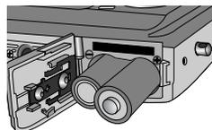
3. Чтобы закрыть крышку отсека батарей, сдвиньте ее до щелчка.
