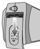
1. Сдвиньте крышку отсека батарей в направлении стрелки и откройте ее.
