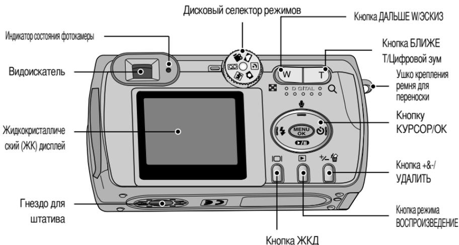
\* При съемке с цифровым зумом изображение на ЖК-дисплее может отличаться от того, что вы видите в видоискателе. Композиция кадра на снимке будет такой, какой вы ее видите на ЖК-дисплее.
