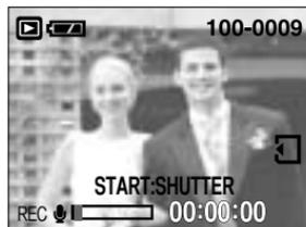
3. Чтобы начать запись, нажмите кнопку спуска. На ЖК-дисплее появится индикатор записи [REC], как показано рядом, и звук будет записываться в течение 10 сек.
