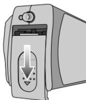
2. Держа карту памяти лицевой стороной к передней панели фотокамеры (объективу) и контактными площадками к задней панели (ЖК-дисплею), вставьте ее в слот для карты до щелчка.
