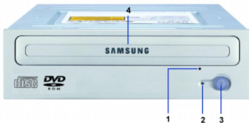
1. Отверстие для аварийного извлечения диска (если отсек для диска не открывается при нажатии вами кнопки выгрузки диска, выключите питание компьютера, вставьте в отверстие булавку или распрямленную скрепку и затем с усилием толкайте булавку или скрепку внутрь)
