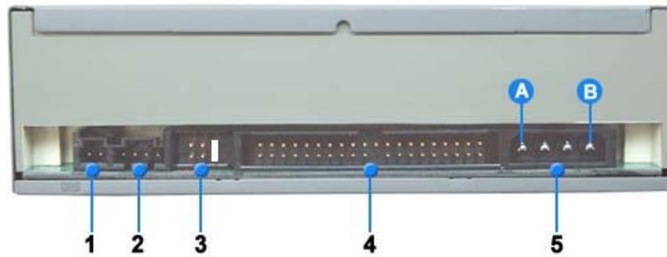
1. Двухконтактный разъем выхода цифрового аудио сигнала для использования с звуковой платой или платой декодера MPEG, поддерживающей функции обработки цифрового аудио сигнала
