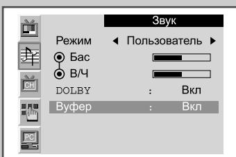
**Если встроенные вуфера выключены, то звук выводится на внешние вуфера.**
