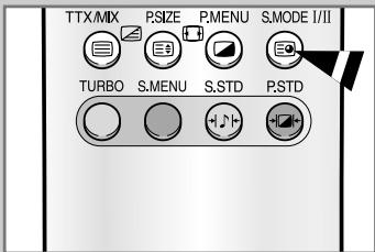
Кнопка “S.MODE” используется для отображения/управления обработкой и выводом звукового сигнала. При включении питания автоматически устанавливается режим “Двойной-I” или “Стерео” в зависимости от текущих параметров передачи.
