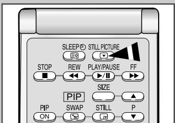
Нажмите кнопку "STILL PICTURE" на пульте ДУ, чтобы зафиксировать на экране текущий кадр изображения. При включенном режиме PIP изображение в дополнительном окне PIP также фиксируется. Для возврата в нормальный режим просмотра нажмите кнопку "STILL PICTURE" еще раз.
