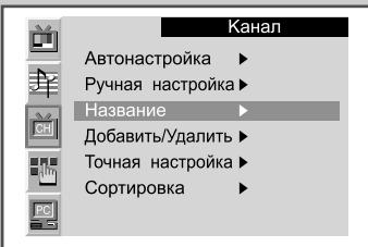
Если информация о названиях каналов транслируется телевизионной станцией при сохранении каналов вручную или при автоматическом сохранении каналов, то названия присваиваются каналам автоматически.
