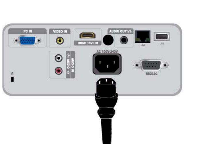
1. Вставьте кабель питания в разъем питания на задней панели проектора.
