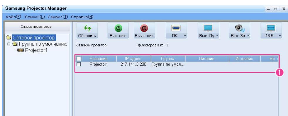
**1** : В режиме реального времени можно просмотреть такие сведения о проекторе как Name, IP Address, Group, состояние Power On/Off, LAMP lifespan, ошибки в работе (отображаются значками) и т.д.
