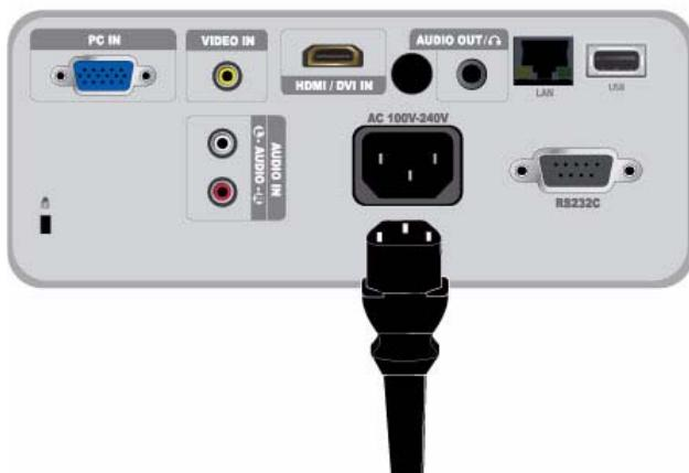
1. Вставьте кабель питания в разъем питания на задней панели проектора.
