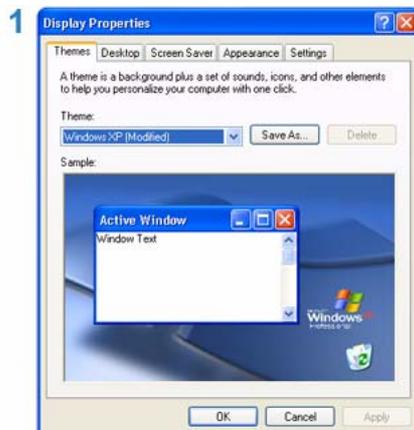
2. Перейдите на вкладку [Настройки] и задайте <Разрешение экрана>. Оптимальное разрешение для проектора – 1280 x 800. Для получения информации о других разрешениях, поддерживаемых проектором, см. таблицу «Режимы отображения: синхронизация с ПК» в разделе 2-8.
