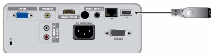
1. Подключите запоминающее устройство USB к порту USB, расположенному на задней панели проектора.
