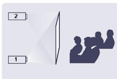
Установка за полупрозрачным экраном
