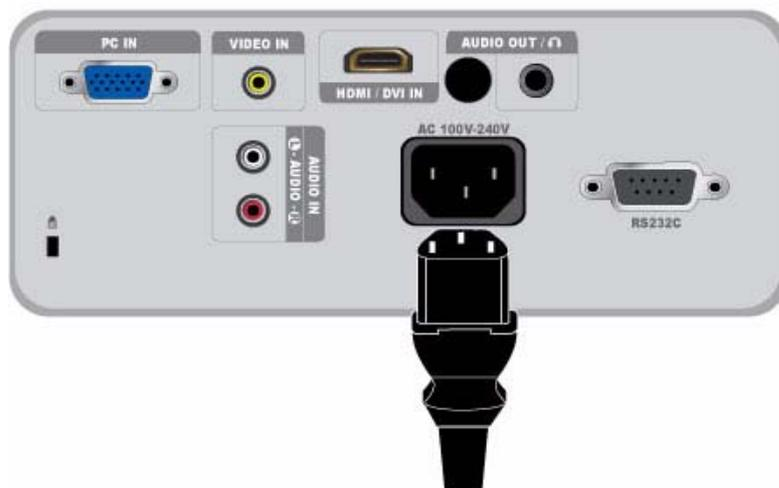
1. Вставьте кабель питания в разъем питания на задней панели проектора.
