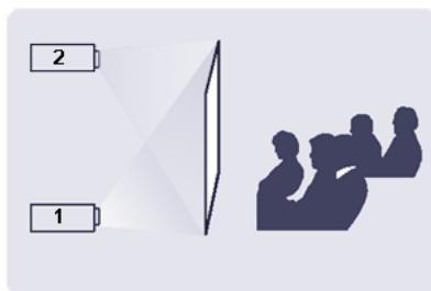
Установка за полупрозрачным экраном
