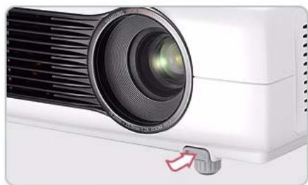
Нажмите кнопки PUSH, как показано на рисунке, чтобы отрегулировать ножки и выровнять проектор.
