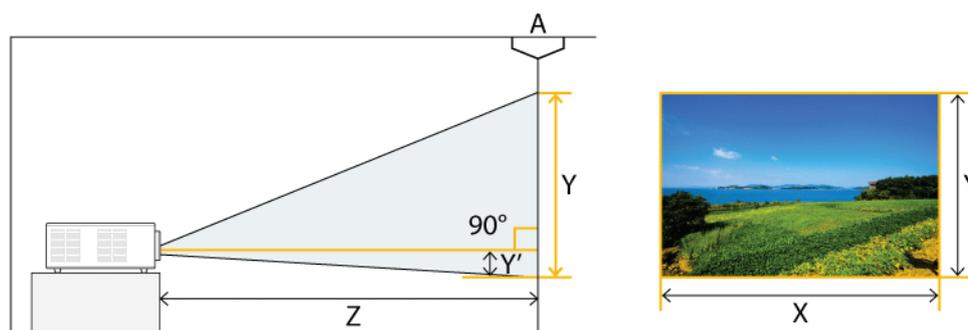
**А. Экран/Z. Расстояние от проектора до экрана/Y'. Расстояние от центра объектива до нижней части изображения**
