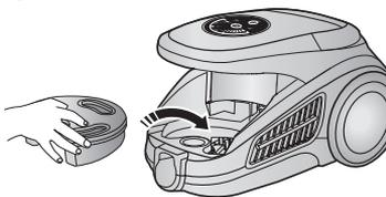
Установите кассету предмоторного фильтра на прежнее место
