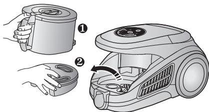
Извлеките контейнер пылесборника и кассету предмоторного фильтра
