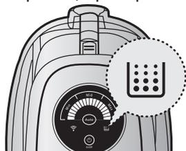
При снижении мощности всасывания загорается лампа. Если загорается индикатор, следует почистить пылесборник.
