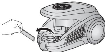
Извлеките фильтр защиты двигателя из пылесоса. Вытряхните пыль из фильтра и установите его назад в пылесос.
