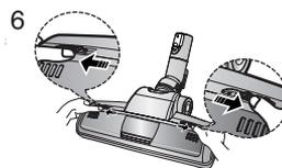
6 Установите на место прозрачную экранирующую крышку, нажав ее до щелчка.
