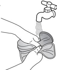
Промойте микрофильтр и кассету водой
