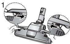
1 Нажмите кнопку «Открыть» («Открыть») на прозрачной крышке, чтобы снять крышку.
