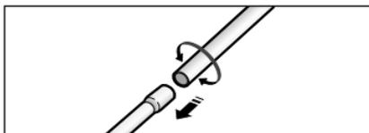
3) Наденьте насадку на трубку всасывания.
