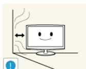
При установке устройства отодвигните его от стены как минимум на 10 см для обеспечения вентиляции.
