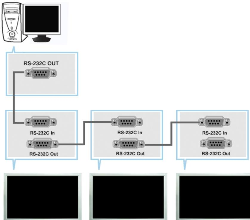
Программа управления несколькими мониторами (Multiple Display Control; MDC) представляет собой приложение, позволяющее работать на ПК одновременно с несколькими мониторами. Для связи между ПК и монитором используется стандартный последовательный интерфейс RS-232C. Поэтому между последовательными портами ПК и монитором необходимо использовать кабель последовательного интерфейса.
