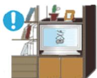
▶ **Не устанавливайте изделие в места с плохой вентиляцией, например, в книжные полки, в стенной шкаф и т.д.**
