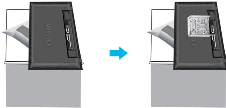
1. Вставьте четыре держателя кронштейна **B** для монитора в прорези настенного кронштейна **A**.
