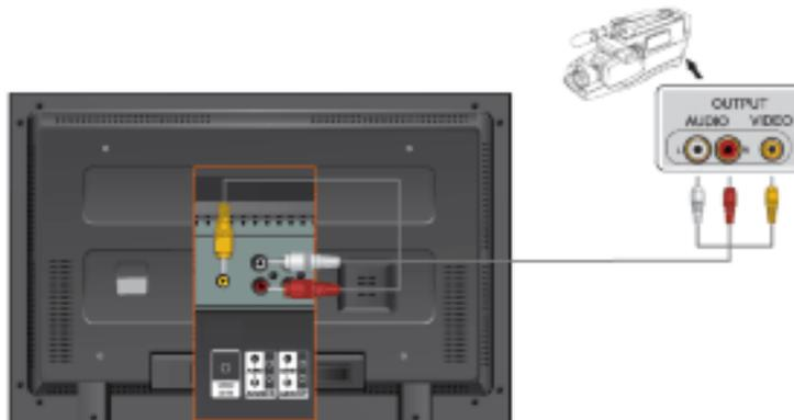
1. Найдите разъемы аудио-видеовыхода на видеокамере. Как правило, они располагаются по бокам или сзади видеокамеры. Подсоедините аудиокабели к разъемам AUDIO OUTPUT на видеокамере и к разъему AV AUDIO IN [L-AUDIO-R] на ЖК-дисплее.
