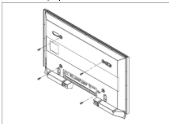
2. Вставьте винт В в пластиковый фиксатор.
