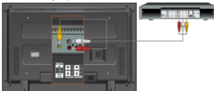
1. Подсоедините порт DVD-проигрывателя, видеомагнитофона (видеоприставки DVD/цифрового ТВ) к порту [R-AUDIO-L] ЖК-монитора.
