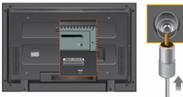
1. Подключите кабель SATV или кабель ТВ-антенны к порту «ANT IN» на задней панели ЖК-монитора.
