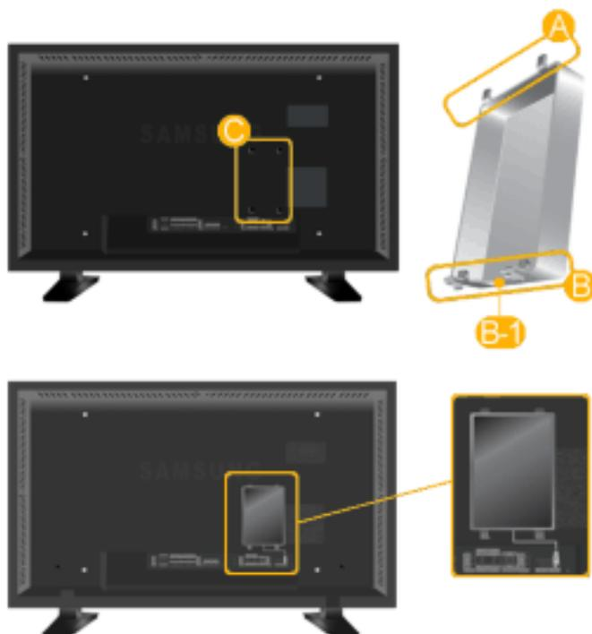
1. Вставьте **A** в паз в верхней части **C**, затем правильно расположите и вожмите **B** в паз в нижней части **C**. Кабель USB внешнего жесткого диска можно подсоединить через **B-1** к разъему USB на мониторе.
