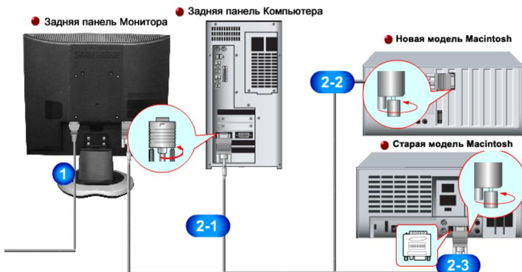
1. Подсоедините электрический шнур Вашего монитора к разъему питания на задней панели монитора. Включите шнур в ближайшую розетку.
