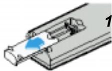
**1** Снимите крышку отсека для батарей, расположенную на задней стороне пульта, нажав на нее и сдвинув в направлении, указанном стрелкой.
