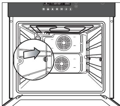
3. Вставьте второй винт в переднее резьбовое отверстие боковой стенки камеры таким образом, чтобы он вошел в передний вырез боковой направляющей. Затем затяните оба винта, поворачивая их по часовой стрелке.
