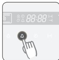
**2** Для снятия блокировки нажмите одновременно кнопки **Лампочка** и **Время** и удерживайте их нажатыми в течение 3 секунд.
