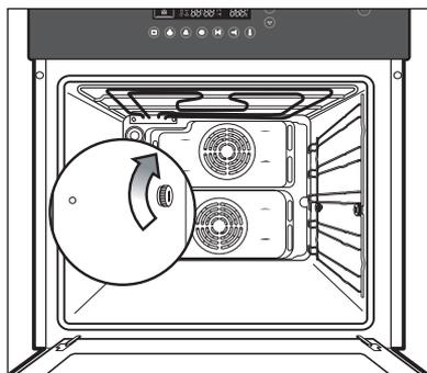
2. Вставьте боковую направляющую, перемещая ее U-образную прорезь под головку винта. Затем продвиньте боковую направляющую вперед до упора по направлению к винту.
