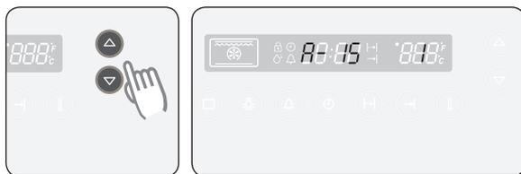
**3** Выберите требуемый вес с помощью кнопок **Время/Температура**. На дисплее отображается время (мин:сек) и через 5 секунд после выбора веса начинается обратный отсчет времени. Если в рецепте не предусмотрено время прогрева, на дисплее отображается время, оставшееся для приготовления блюда (час.:мин.).
