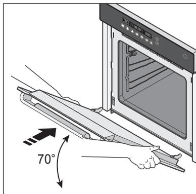
2. Поверните дверцу в горизонтальное положение и закройте защелки.
