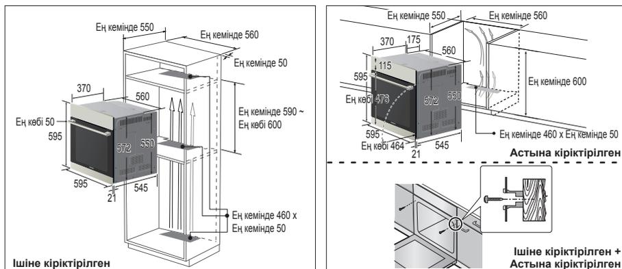
Құрылғыны ас үй жиһазына әбден итеріп кіргізіп, 2 бұранданың көмегімен пештің екі жағын әбден бекітіңіз. Құрылғы мен көршілес тұрған ас үй жиһазының арасында кем дегенде 5 мм орын қалуын қамтамасыз етіңіз.
