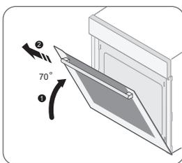
2. Прикройте дверцу на угол примерно 70°. Двумя руками возьмитесь за обе стороны дверцы посередине и тяните дверцу на себя и вверх до тех пор, пока петли полностью не выйдут из своих отверстий.
