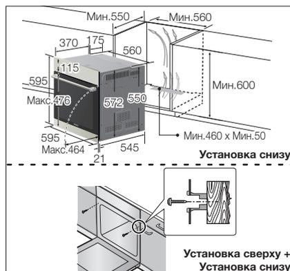
Полностью задвиньте устройство в шкаф и надежно зафиксируйте с обеих сторон двумя винтами. Необходимо оставить зазор (не менее 5 мм) между устройством и смежным шкафом.
