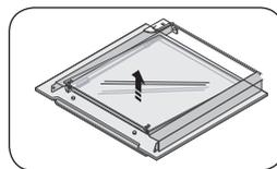
**3.** Підніміть скло 2 і вийміть два тримачі вгорі, почистьте скло теплою водою чи миючим засобом і витріть насухо м'якою чистою ганчіркою.
