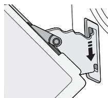
**3.** Після чищення повторіть дії кроків 1 і 2 у зворотному порядку, щоб встановити дверцята. Затискачі на завісах слід закрити з обох боків.
