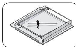
3. Поднимите стекло 2 и очистите его теплой водой или моющим средством, а затем вытрите насухо мягкой чистой тканью.
