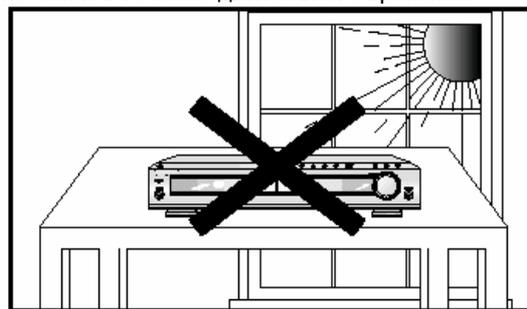
Избегайте воздействия на систему прямого солнечного света и других источников тепла. Это может привести к перегреву системы и нарушению ее нормальной работы.
