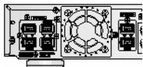
Охлаждающий вентилятор рассеивает тепло, образующееся внутри в результате работы системы. Вентилятор начинает вращаться автоматически, подавая внутрь системы более холодный воздух снаружи.
