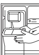
Если необходимо промыть резервуар, приподнимите его, а затем наклоните наружу, предварительно отсоединив соединительный шланг.
