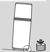
Если холодильник наклонен вправо, поверните правую переднюю регулировочную ножку против часовой стрелки.
