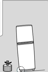
Если холодильник наклонен влево, поверните левую переднюю регулировочную ножку против часовой стрелки.
