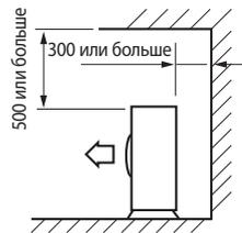
◆ Если стены блокируют переднюю и заднюю стороны наружного блока
