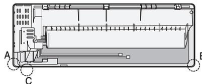
1. Вырежьте подходящую продавленную часть (A, B, C) на задней панели внутреннего блока, если вы подключаете эту трубку непосредственно с тыльной стороны.
