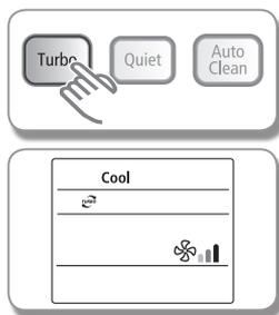
Нажмите кнопку **Turbo** (Турбо) на пульте дистанционного управления в режиме **Cool** (Охлаждение).
