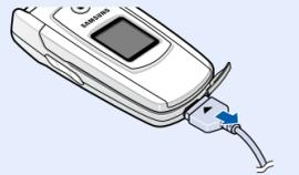
**Примечание.** Перед извлечением аккумулятора необходимо обязательно отсоединить зарядное устройство. В противном случае можно повредить телефон.
