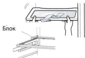
2. Извлеките выдвижной ящик & для хранения овощей и фруктов, потянув его вперед. Придерживая выдвижной ящик одной рукой, немножко приподнимите его и извлеките из холодильника.
