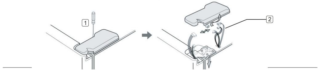
2. Открутите винты петель **3** и напольный винт **4**, поворачивая отвертку против движения часовой стрелки, затем снимите верхнюю петлю **5**. Следите за тем, чтобы дверца не упала на вас во время ее снятия.
