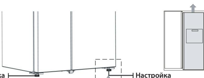
Вставьте ключ в осевое отверстие внизу нижней петли и поверните его; повернувшись лицом к дверце холодильника, поворачивайте его слева направо.
