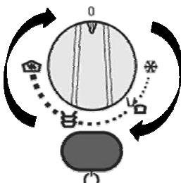
Na panelu sterowania znajduje się pokrętło do nastawiania temperatury oraz przełącznik włączenie/ wyłączenie. Panel sterowania jest widoczny tylko wówczas, gdy szuflada jest otwarta.
