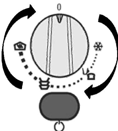
Die Bedienelemente bestehen aus dem Temperaturknebel und dem Ein-/Aus-Schalter. Sie sind nur sichtbar, wenn die Geschirrschublade geöffnet ist. Bei geschlossener Schublade kann man durch das Kontrollfeld in der Gerätefront sehen, ob das Gerät eingeschaltet ist.
