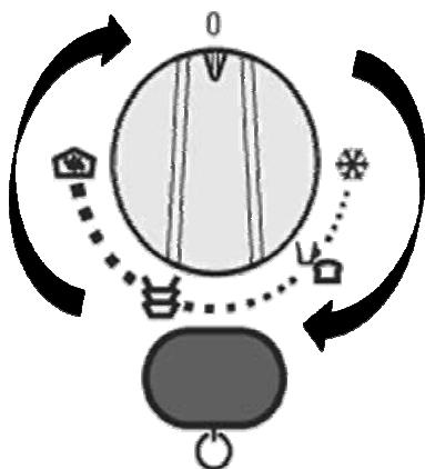
Le tableau de commandes n'est visible que lorsque le tiroir est ouvert. Il comporte un bouton sélecteur de température et l'interrupteur marche/arrêt.
