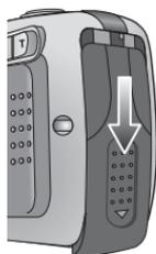
1. Abra a tampa do compartimento das baterias pressionando-a na direção da seta.
