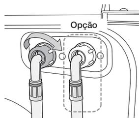
6. Abra a alimentação de água e certifique-se de que não existem fugas de água da válvula de água, da torneira ou do adaptador. Se houver uma fuga de água, repita os passos anteriores.
