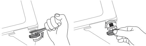
3. Quando a máquina de lavar roupa estiver nivelada, aperte as porcas utilizando a chave de fendas fornecida com a sua máquina de lavar roupa.
