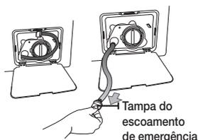
4. Segure a tampa que se encontra na extremidade do tubo de escoamento de emergência e puxe-a cuidadosamente para fora.
