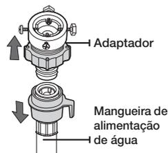
2. Utilizando primeiro uma chave de parafusos em forma de cruz ("+"), afrouxe os quatro parafusos do adaptador. Em seguida, pegue no adaptador e rode a peça (2), seguindo a direcção da seta, até obter uma folga de 5 mm.
