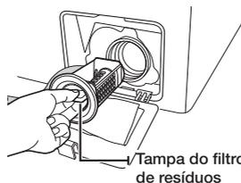
5. Lave o filtro de resíduos para retirar a sujidade ou qualquer outro material. Certifique-se de que o propulsor da bomba de escoamento, que se encontra por trás do filtro de resíduos, não está entupido.
