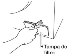
3. Abra a tampa de escoamento de emergência, puxando-a.
