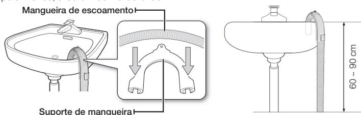
3. **Num tubo de escoamento:** Recomenda-se que utilize um tubo vertical com 65 cm de altura. Não pode ter menos de 60 cm nem mais de 90 cm de comprimento.
