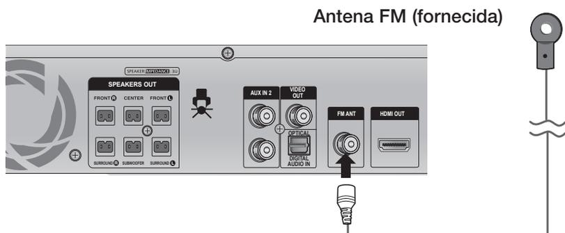
1. Acople a antena FM fornecida ao conector de antena FM.
