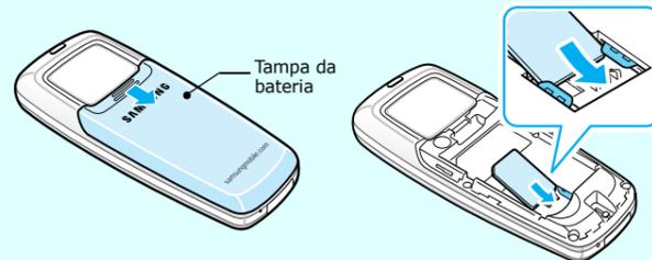
2. Instale a bateria e substitua a tampa.
