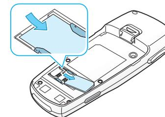
4. Coloque a bateria de modo a que as patilhas fiquem alinhadas com os encaixes no fundo do telefone.
