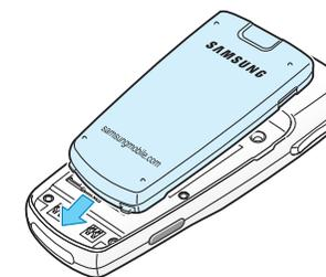
5. Faça pressão sobre a bateria até ouvir um clique que indica que foi encaixada na posição correcta. Certifique-se de que a bateria está correctamente instalada antes de ligar o telefone.
