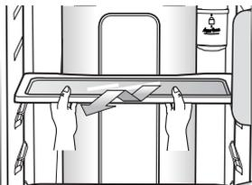
2. Remova a prateleira de vegetais e fruta pressionando os entalhes que se encontram no interior dos lados esquerdo e direito da tampa da caixa de vegetais/caixa seca e retire-a, puxando-a para a frente. Segurando a gaveta com uma mão, levante-a um pouco enquanto a puxa para a frente e retire-a do frigorífico.
