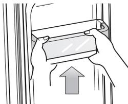
3. Retire a gaveta de plástico puxando-a para fora e levantando-a ligeiramente.
