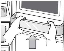
4. A PRATELEIRA Z está fixa à parede do armário do aparelho. Retire-a, fazendo-a deslizar para cima e levantando-a para fora das projecções.
