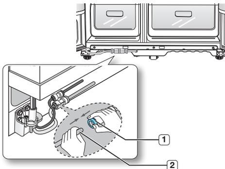
2. O tubo da água deve ser totalmente introduzido no centro do acoplador transparente para evitar uma fuga de água no dispensador.
