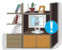
● **Não instale o produto em locais com condições de ventilação inadequadas como, por exemplo, uma estante, um armário, etc.**
