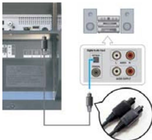
1. Ligue um conjunto de cabos de áudio entre as tomadas Digital Audio Input no AUDIO SYSTEM e as tomadas **DIGITAL AUDIO OUT** no monitor.
