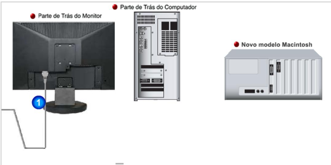
**1** Ligue o cabo de alimentação do monitor à porta de alimentação situada na parte de trás do monitor. Insira o cabo de alimentação do monitor numa tomada que esteja próxima.
