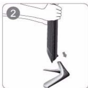
Segure a parte principal do corpo do produto com a mão, conforme ilustrado pela figura. Coloque a parte principal do produto sobre a base na direcção da seta, conforme ilustrado na figura.
