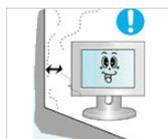
Para permitir a ventilação, mantenha uma distância de, pelo menos, 10 cm da parede quando instalar o produto.
