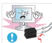
Não coloque o transformador em cima de outro transformador.
