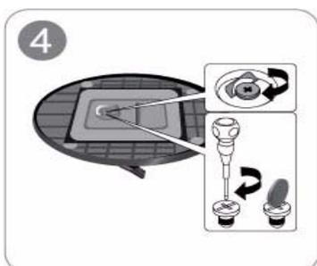
Rode o parafuso de ligação existente na parte inferior da base até este ficar totalmente fixo.
