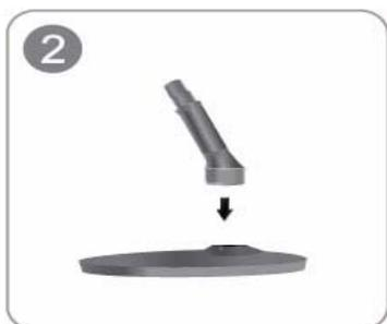
Introduza o conector na base, na direcção ilustrada pela figura.
