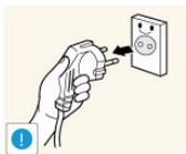
Quando desligar a ficha de alimentação da tomada de parede, segure-a pela ficha e não pelo cabo.
