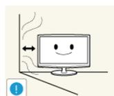
Para permitir a ventilação, mantenha uma distância de, pelo menos, 10 cm da parede quando instalar o produto.
