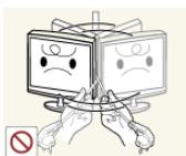
Evite levantar ou mover o produto segurando-o apenas pelo cabo de alimentação ou pelo cabo de sinal.
