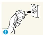
Ligue o cabo de alimentação a uma tomada de parede com ligação à terra (apenas para equipamento de isolamento de classe 1).
