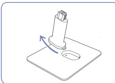
Retire o conector da base puxando-o na direcção da seta, conforme ilustrado na figura.
