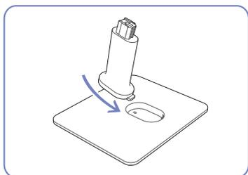
Introduza o conector na base, na direcção ilustrada pela figura.
