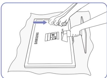
Segurando a haste da base com uma mão, bata com a outra mão fechada na parte superior da base na direcção da seta, para soltar a parte inferior da base.
