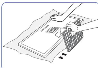
Segure a parte principal do corpo do produto com a mão, conforme ilustrado pela figura. Empurre a base montada para a parte principal do corpo, na direcção da seta, conforme ilustrado na figura.
