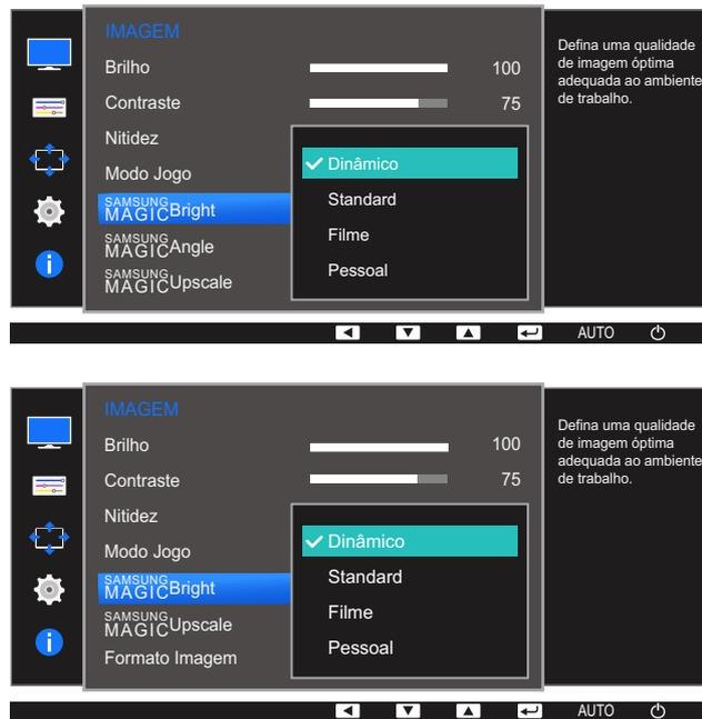
Se a entrada externa estiver ligada através de HDMI, e o **Modo PC/AV** estiver definido para **AV**, a opção **SAMSUNG MAGICBright** tem quatro definições de imagem automáticas (**Dinâmico**, **Standard**, **Filme** e **Pessoal**) que são predefinidas na fábrica. Pode activar **Dinâmico**, **Standard**, **Filme** ou **Pessoal**. Pode seleccionar **Pessoal** para voltar a chamar automaticamente as definições de imagem personalizadas.
