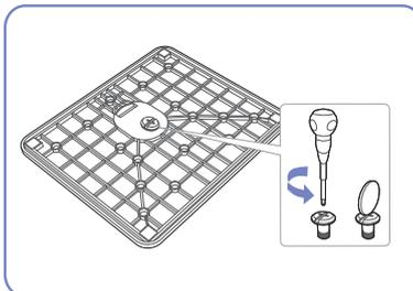
Rode o parafuso de ligação existente na parte inferior da base para separá-la.
